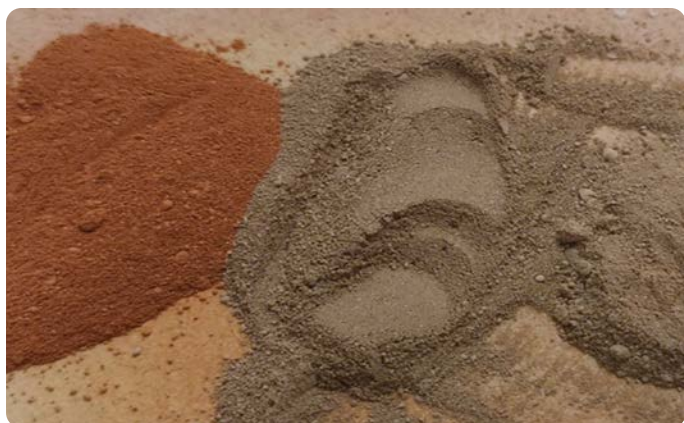
具有颜色控制功能的粘土煅烧炉 使用颜色控制工艺与否对成品颜色影响的对比
