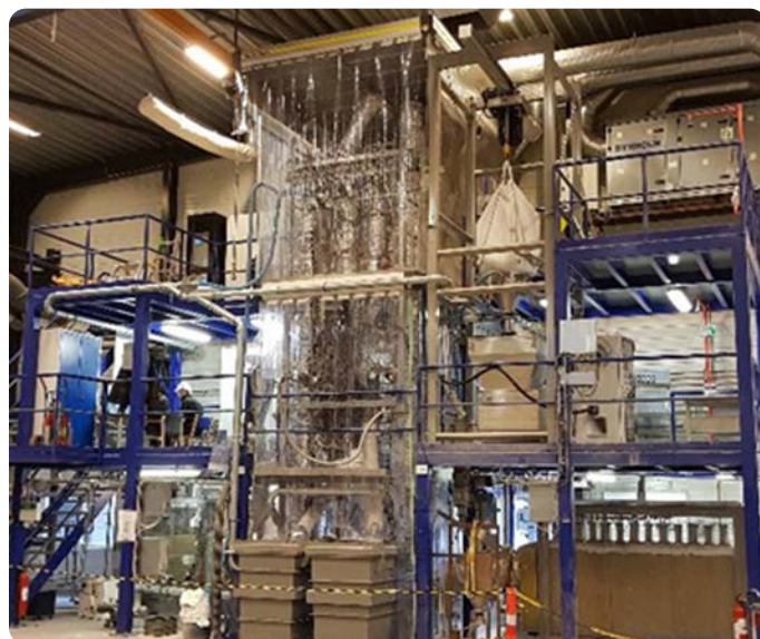
SCM烧成中试系统安装-丹麦丹尼尔 Fuller Technologies 公司研发中心
